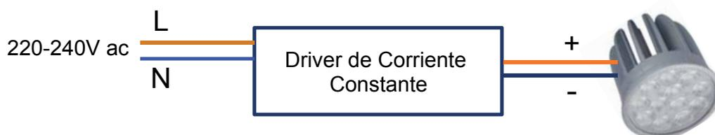
Tipo B: Conexión de un módulo con regulación de corte de fase
