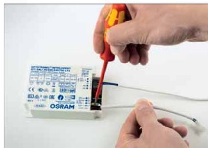
Paso 2: Configuración del driver y conexión de los cables DALI
