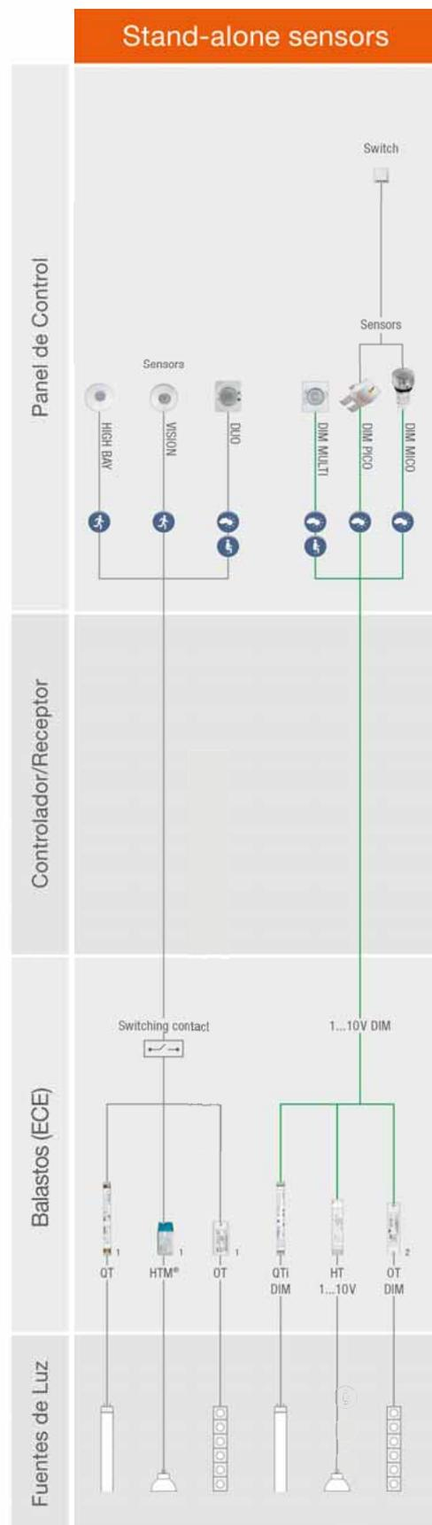
Los sensores proporcionan la base para ahorrar energía mediante la regulación en función de la luz natural o de la presencia. Con la ayuda de los sensores de luz se mide la luz natural disponible y se suplementa con la luz artificial necesaria. Con sensores de presencia/movimiento el sistema se apaga/enciende dependiendo de si hay o no gente en la habitación. Con esta clase de sensores se pueden obtener ahorros de hasta un 70%\*.
