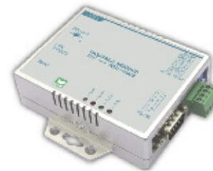
Posibilita el acceso remoto mediante Internet a redes de contadores de energía tipo CONTAX, CONTAX BUS o ANRET con conexión RS485 (RTU o ASCII).
