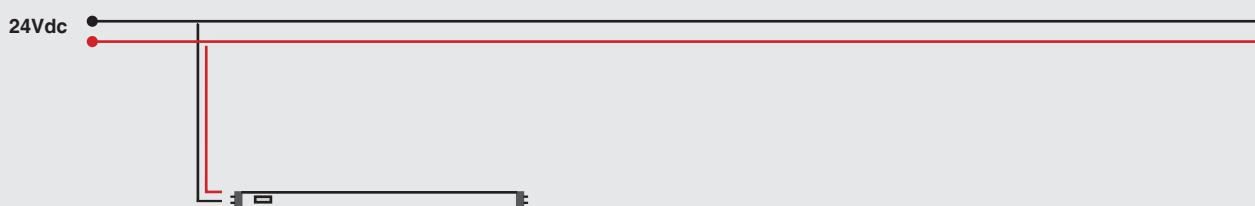
ALIMENTAR A 24VDC POR EL LADO DE LA ETIQUETA · IT | ALIMENTARE A 24VDC NEL LATO DELL'ETICHETTA · PT | ALIMENTAR A 24VDC PELO LADO DA ETIQUETA · FR | ALIMENTER À 24VDC SUR LE CÔTÉ DE L'ÉTIQUETTE · EN | POWER TO 24VDC THROUGH THE LABELLED SIDE · DE | MIT 24 VDC AUF DER SEITE MIT DER ETIKETTE VERSORGEN.
