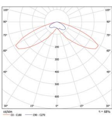
Ura LED con óptica asimétrica 150° sin cierre o con cierre de policarbonato transparente.
