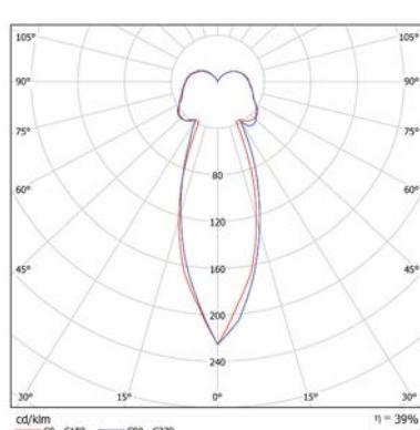
Ura LED con óptica simétrica 150° y cierre de policarbonato mate.
