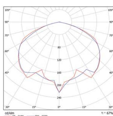
Ura LED con óptica simétrica 150° sin cierre o con cierre de policarbonato transparente.
